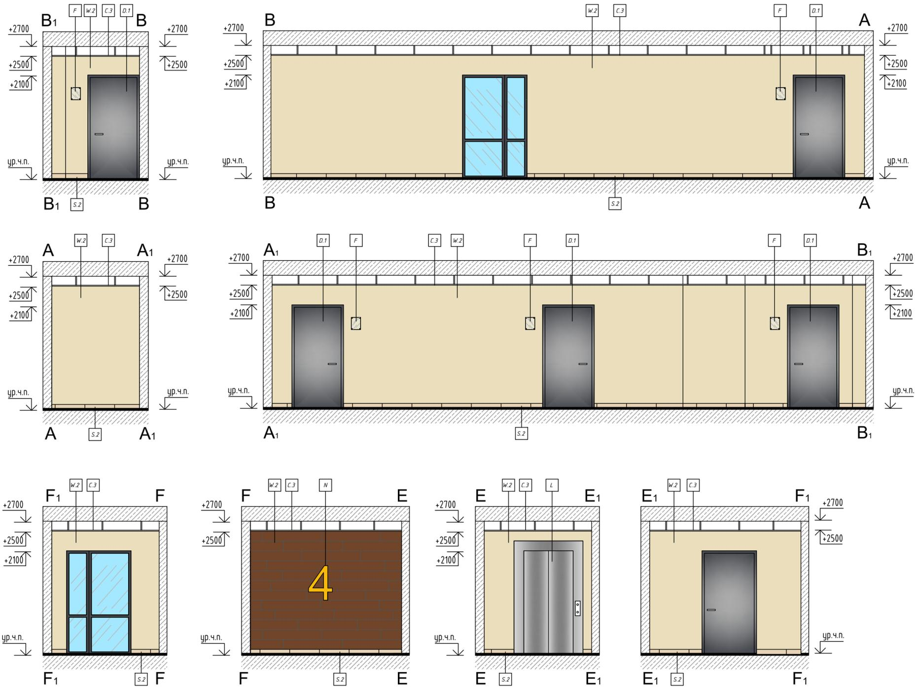
1 РАЗВЕРТКИ СТЕН ТИПОВОГО ЭТАЖА
